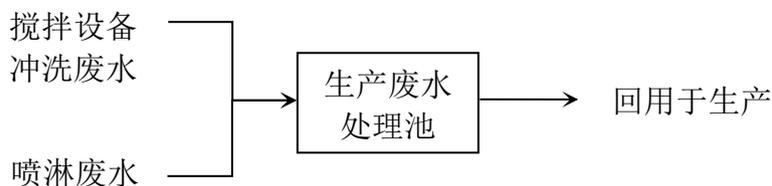
图 4-4 生产废水处理回用流程示意图
