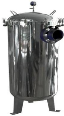
精密过滤器能够对水处理系统起到保护作用，同时确保出水水质符合标准。它的内部使用装线绕蜂房式滤芯或熔喷滤芯，用于饮用水、生活用水、电子、印染、纺织、环保等行业的生产用水过滤、酸碱过滤及反渗透 RO 膜前保安过滤，具有通量大、耗材成本低等特点，进出口、排污管道配自动控制阀、控制器、可自动反冲洗。
