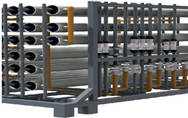
反渗透是 1960 年美国加利福尼亚大学的洛布与素里拉简(Sourirtajan)发明的一项高新膜分离技术，其孔径很小，大都 $\leq 10 \times 10^{-10}$  (10Å)，它能去除滤液中的离子范围和分子量很小的有机物，如细菌、病毒、热源等。它已广泛用于海水或苦咸水淡化、电子、医药用纯水、饮用水、太空水的生产，还应用于生物、医学工程。
