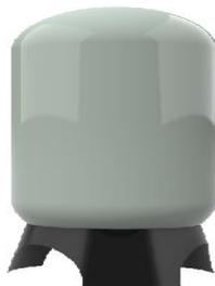
砂滤是给水处理和废水处理中分离水中不溶物质的一种快速方法，以天然石英砂通常还有锰砂和无烟煤作为滤料的水过滤处理工艺过程，其作用是截留水中的大分子固体颗粒和胶体，使水澄清。
